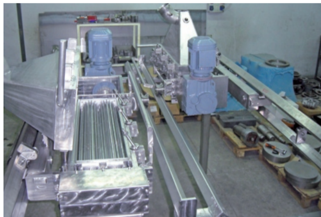
Impianto di estrusione preassemblato
