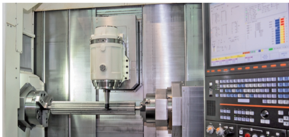
Particolare dell'estrusore lavorato su macchina multitasking
